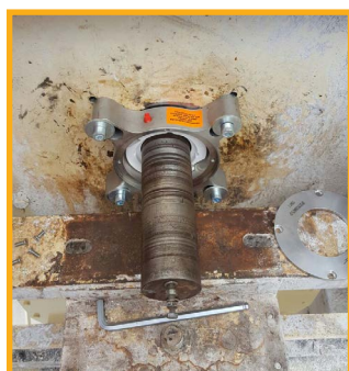
Tapa de la carcasa con la junta tórica montadas en la pared de la máquina.
