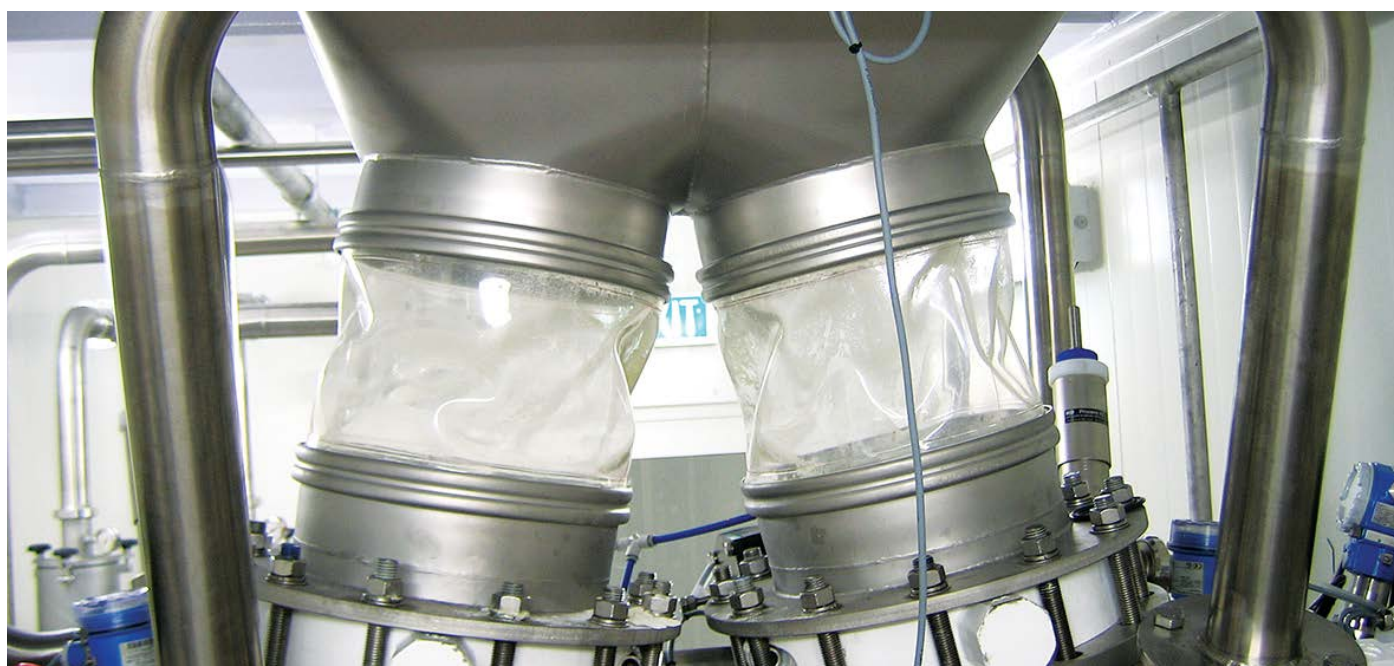
Conectores BFM que trabajan con materiales pulverulentos.
