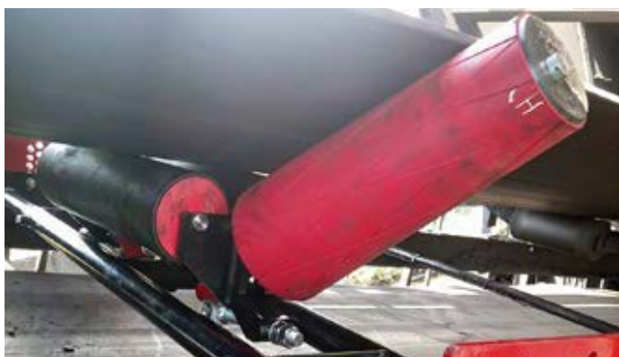
Rodillos laterales revestidos con goma con alta resistencia.
