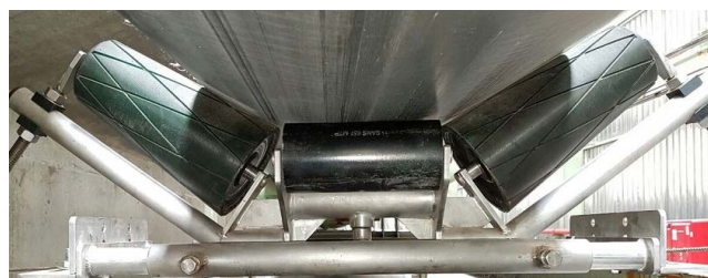
Modelo estándar con estructura de acero inoxidable.
