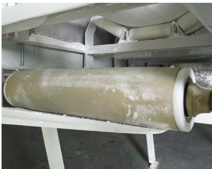
Recubrimiento de poliuretano con grado alimentario.
