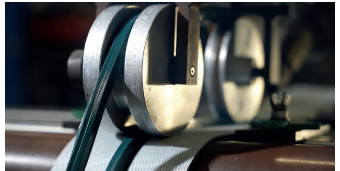
Incorporación de perfiles longitudinales.
