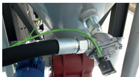
AirSweep para mejorar el flujo de material en una tolva.
