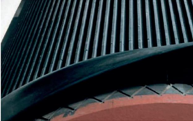
Banda filtrante | Diseño con ranuras que permiten el filtraje.
