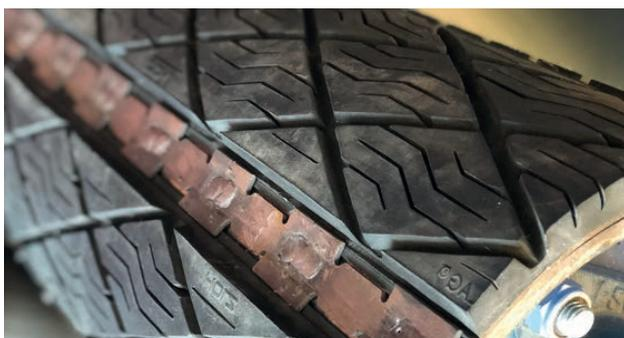
Slide-lag | Módulos de caucho fijados mediante guía doble.
