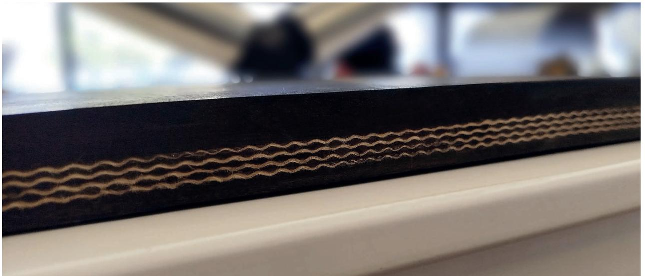
Banda de carcasa textil I Telas y caucho.
