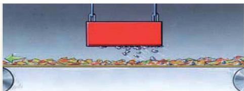
La placa se instala sobre una cinta transportadora de manera que atraiga los materiales ferromagnéticos que pasen sobre la cinta. La altura máxima a la que puede montarse el imán está limitada por el tipo de imanes utilizados, las dimensiones de la placa y el tamaño y características de los hierros a separar.
