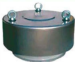
Válvula presión/depresión Protege la estructura del silo de sobrepresiones y depresiones. Tara de presión 0 y 400 mm c.a
