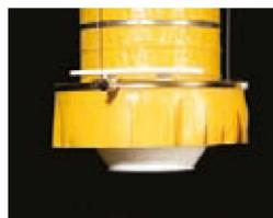
Para carga sobre cisternas hay que subir el faldón y dejarlo en esta posición gracias a los asideros que para ello se han dispuesto. La salida tiene un diseño similar a la salida para cisterna.
