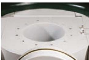
Se pueden acoplar bridas PN10 a todas las entradas, e incorporan 12 tuercas M20 soldadas, o bien 16 tuercas soldadas M24 en la serie 400. Todas las estructuras de entrada se pueden suministrar con acoplamiento para bridas o acoples de manguera para la aspiración.
