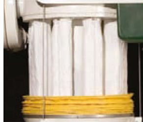
Las mangas filtrantes se montan verticalmente, y se pueden suministrar en diferentes versiones dependiendo del producto descargado.
